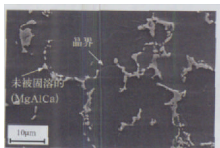
图13 固溶处理16h后M32的组织形貌
